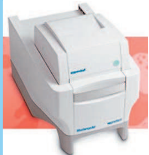
Termociclador con gradiente de temperaturas, que permite la amplificación simultánea de ADN a diferentes condiciones
