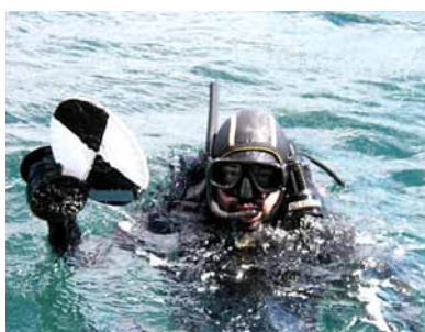
Luego bajará a medir visibilidad horizontal con un disco de Secchi.
